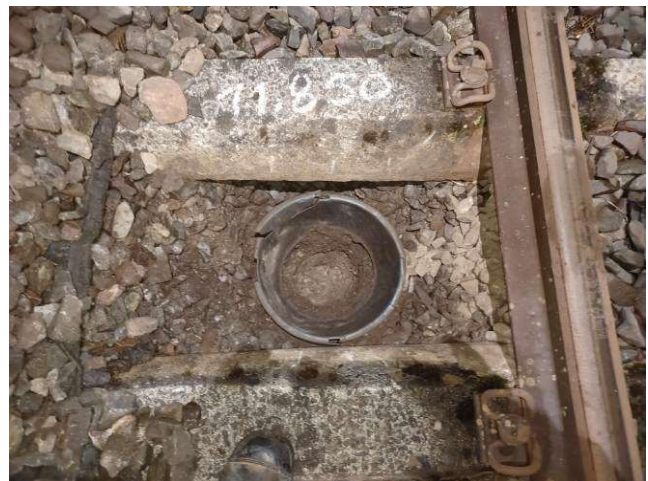
Bild 4: Abschnitt: Langeland – Ottbergen, km 11,850, Schurf im Schwellenfach
