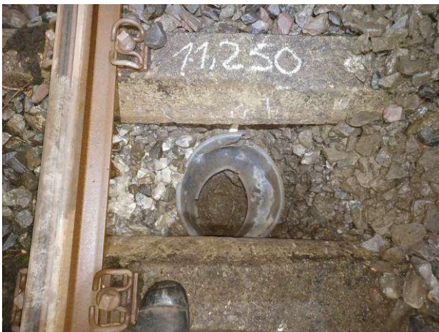
Bild 3: Abschnitt: Langeland – Ottbergen, km 11,250, Schurf im Schwellenfach
