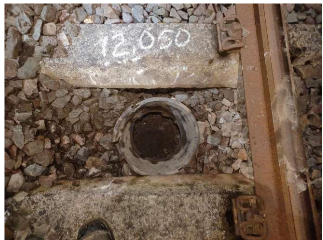
Bild 6: Abschnitt: Langeland – Ottbergen, km 12,050, Schurf im Schwellenfach
